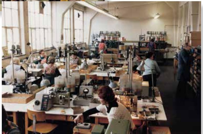
*In der Wickelei ist 1970 ein wichtiger Schritt in Richtung Automatisierung getan. Große Spulwicklerautomaten wickeln die Magnetspulen für die Gebührenzähler.*
