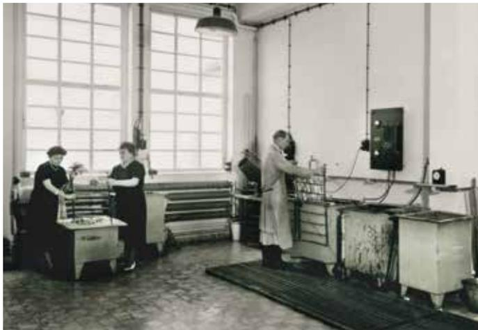
*Bereits beginnend in den 1950er Jahren erhielten die Gebührenzählergrundkörper in der Galvanik per Elektrolyse einen Überzug aus Nickel oder Kupfer. Die Bedeutung der Oberflächenbehandlung stieg mit dem Einzug der Elektronik deutlich an.*
